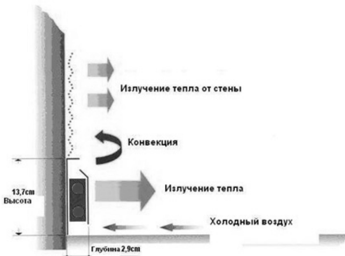
Рис. 2. Принцип работы технологии «теплый плинтус»
