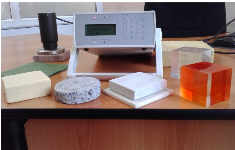
Рис. 1. Интеллектуальная информационно-измерительная система ТФС строительных материалов
