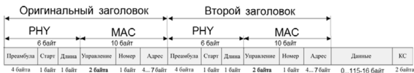
Рис. 1. Структура пакета данных с двойным заголовком
