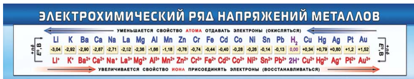
Рис. 1. Электрохимический ряд напряжений металлов
