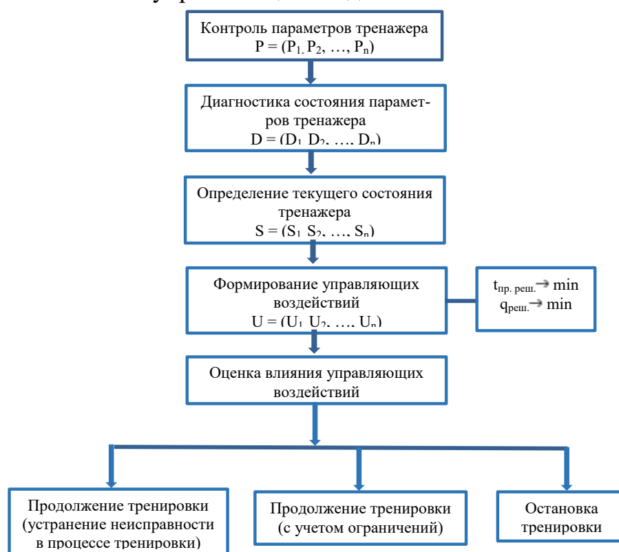
Рисунок 1 - Схема поиска решений при неисправностях тренажеров
