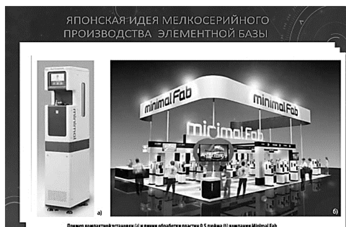
Рис. 3. Пример участка по производству чипов на пластинах диаметром 25 мм
