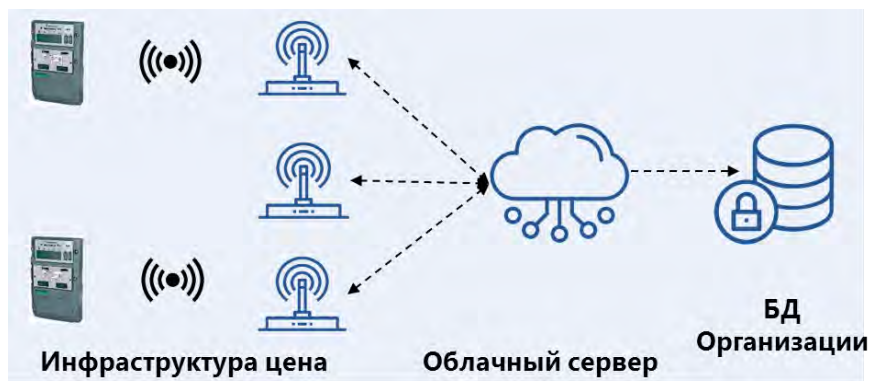
Рис. 1. Сервисы передачи данных с ПУ через сервер LoRaWAN в БД организации.
