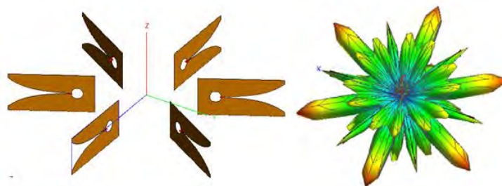
Рис.5. Кольцевая адаптивная антенная решетка, и ее диаграмма направленности
