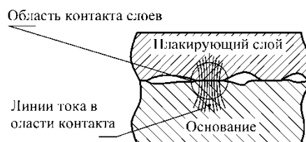
Рис. 2 Несовершенство контакта двух слоев биметалла
