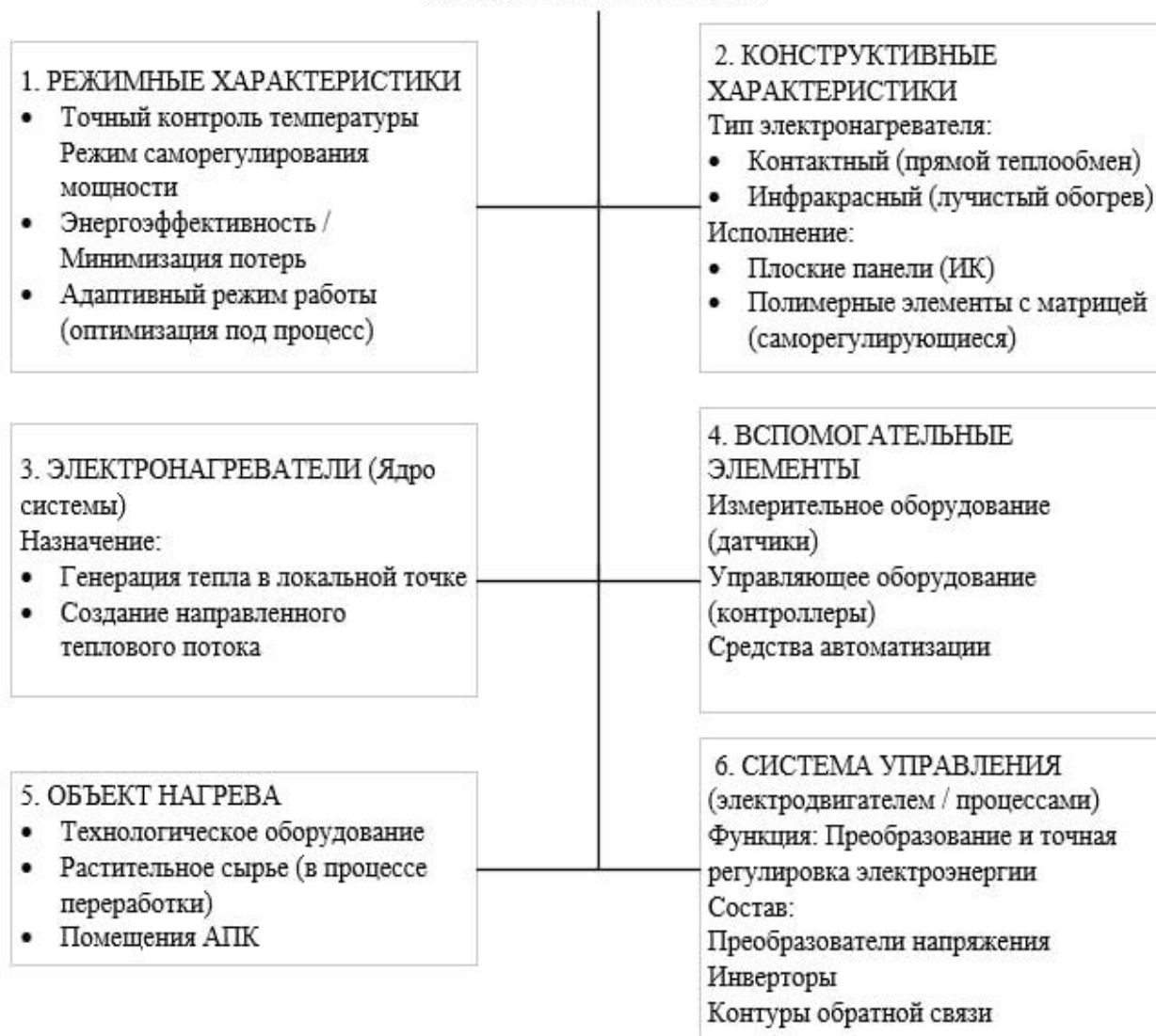
Рис. 1. Блок-схема технологий электронагрева в АПК
