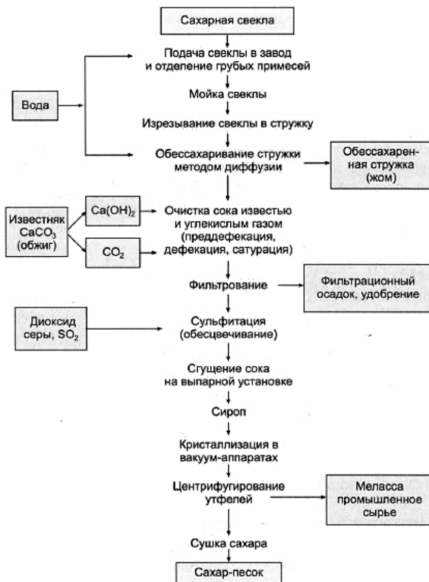
Рис. 1. Принципиальная схема производства сахара из свеклы
