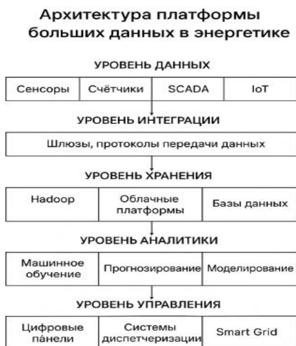
Рис. 2. Архитектура платформы больших данных в энергетике
